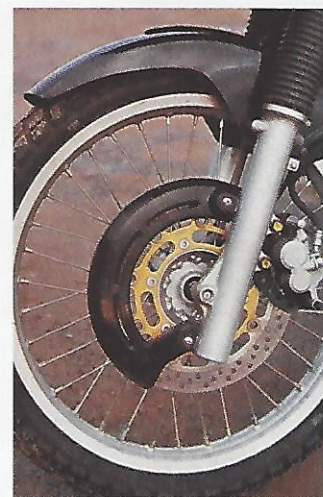
Bremskraftverstärkung: 300er Bremsscheibe vorn ab 1991
