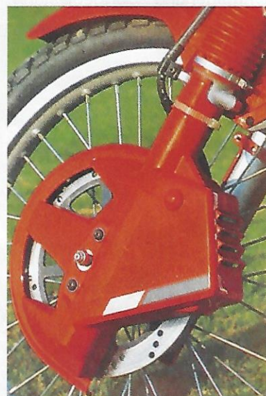
1987 up to date: Die 280er Bremsscheibe vorn mit obligatorischer Verkleidung
